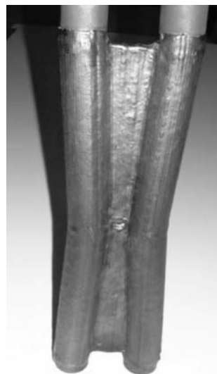
Exemple d'un revêtement à base d'inconel réalisé par laser pour améliorer la fonction de tenue à la corrosion de la pièce
