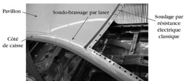
Soudage d'un corps creux
